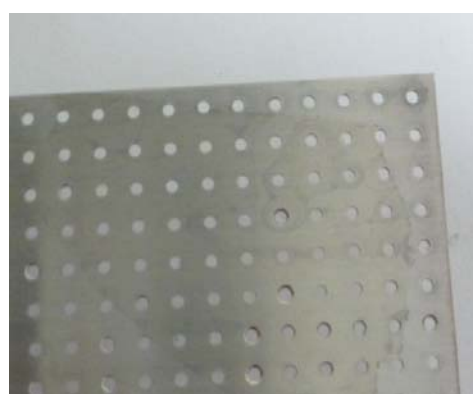
图 2：自支撑纳米级类金刚石膜 (小孔直径孔 1mm)
